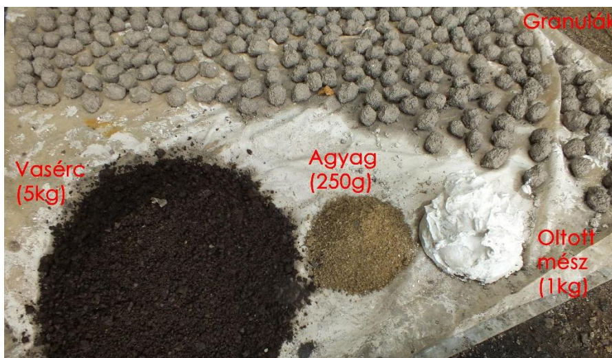
4. ábra: Granulák 1 : 0,2 : 0,05 = érc : oltott mész : agyag arányok mellett
