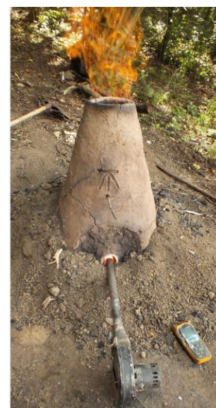
5. Ábra: a) A kohó vázlatos rajza a főbb részekkel és méretekkel. b) A kitisztított kohó, előtte salagködörrel. c) A kohó üzem közben centrifugál ventillátorral fújtatva és hőszigetelő porral körbevéve.
