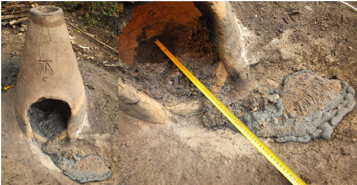
9. ábra: A kohósítás után a kohóban maradt salakmedve és a kohó elé kifolyt folyósalak.
