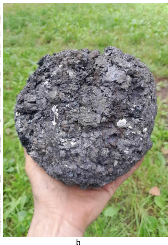
8. ábra: a) A kohósítás salakjai, vasbucája és mellfalazata. b) A tömörített, 6,7kg-os vasbuca.
