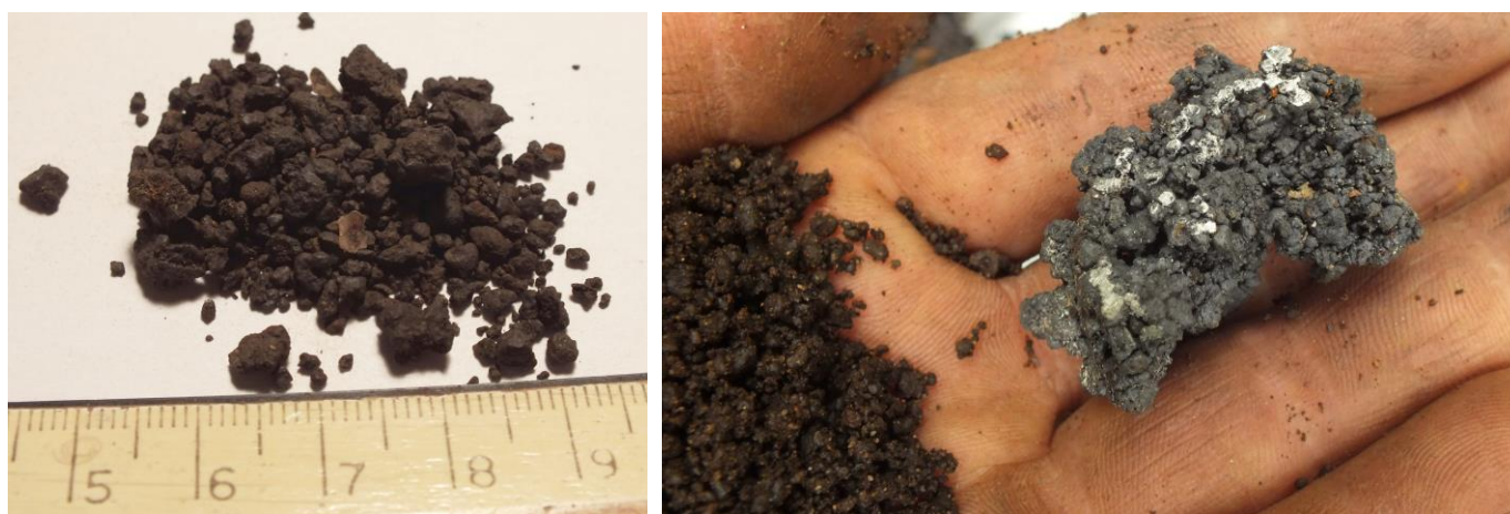
3. ábra: a) Az aprószemű petesmalmi vasérc. b) Fémtisztára csiszolt problémás vasszivacs darabka a laza vaskoronából és az apró szemű petesmalmi gyevasérc.
